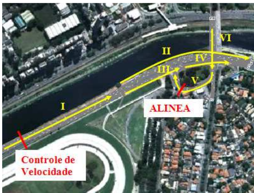
Figura 6-4: Reprodução de parte da malha durante simulação com indicação de trechos de estudo e seções de controle
